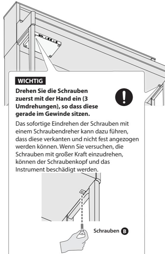
5. Ziehen Sie die Schrauben **B** (2), welche Sie bei Schritt 4 mit der Hand angezogen haben, mit einem Schraubendreher fest ein.
