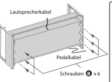
**Ziehen Sie die Schrauben zunächst dreimal von Hand an.**
