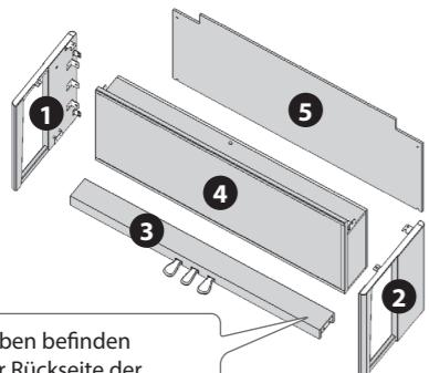
Die Schrauben befinden sich auf der Rückseite der Pedaleiste.
