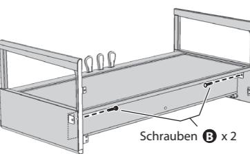
**Ziehen Sie die Schrauben zunächst dreimal von Hand an.**
