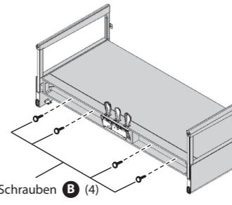
**Ziehen Sie die Schrauben zunächst dreimal von Hand an.**
