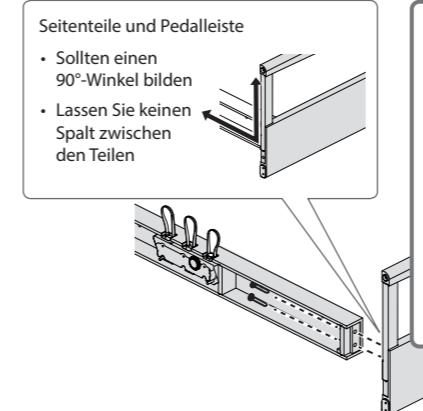
**Ziehen Sie die Schrauben zunächst dreimal von Hand an.**
